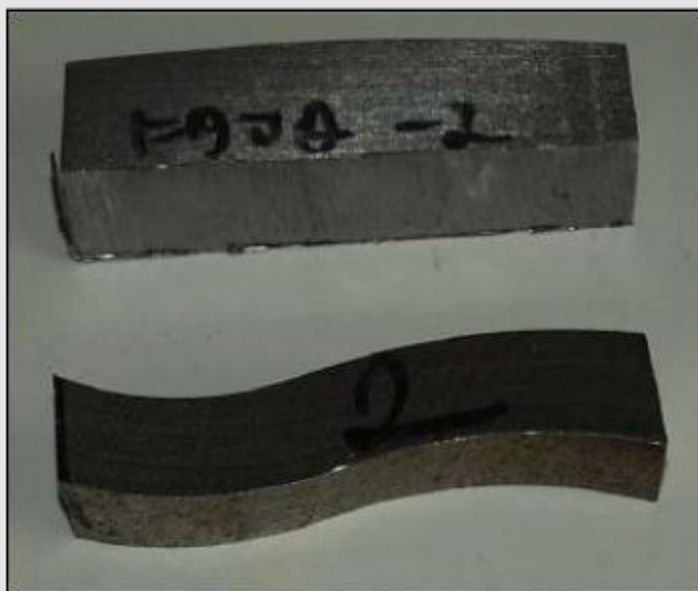
Abb. 2. Vorprodukte zur Herstellung des Probekörpers für den Zugversuch
