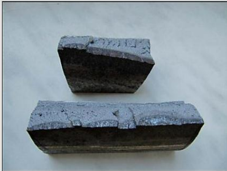
Abb. 5. Teile der Bruchfläche, die für die farktographische Analyse im Elektronenrastermikroskop angewendet sind.
