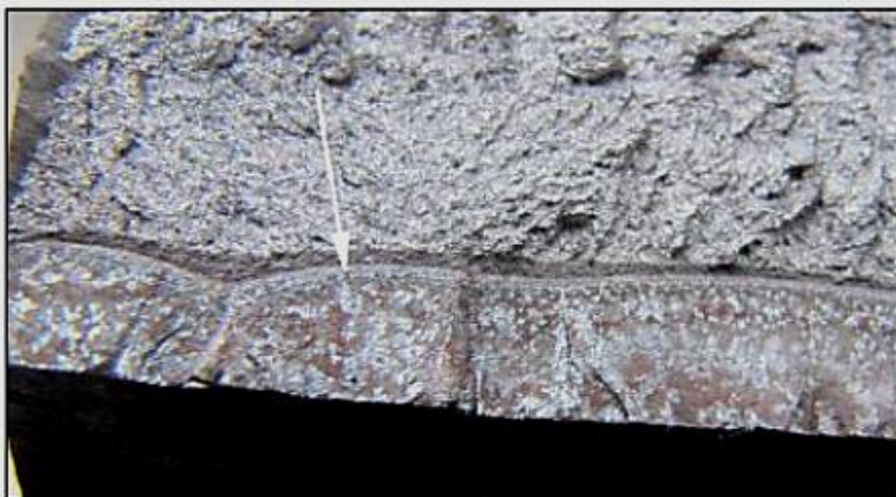
Abb. 9. Fortschrittslinien in der Nähe der Stirn der Ermüdungsrisse
