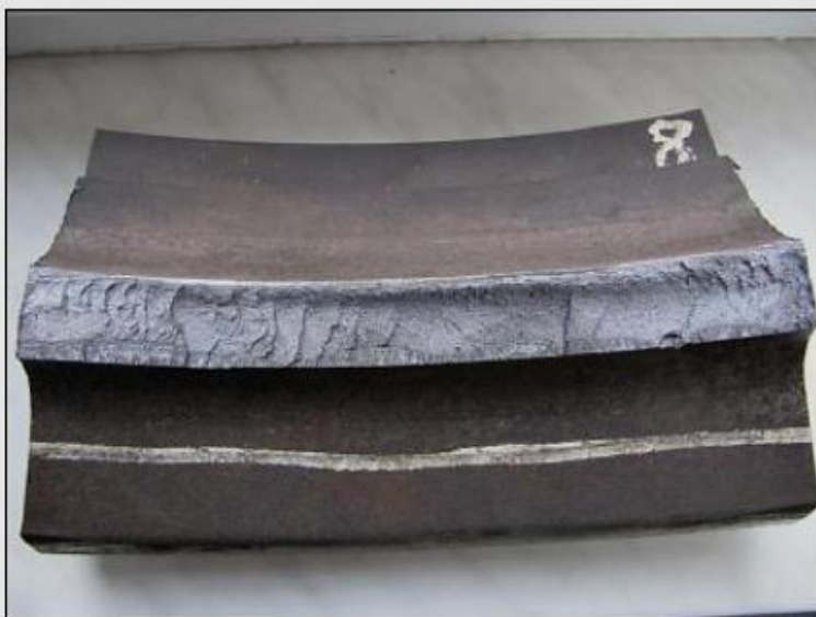
Abb. 1. Gebrochenes Segment – vom Auftraggeber geliefert.
