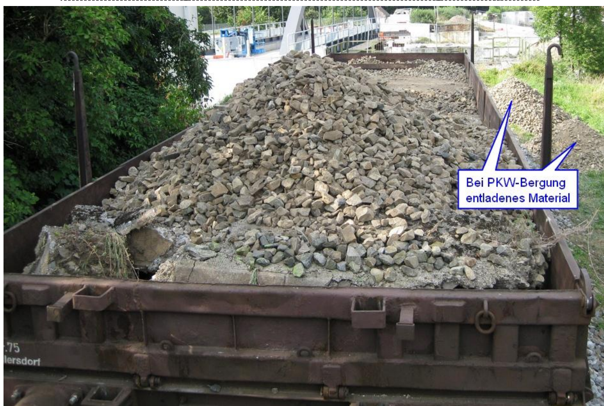
Abbildung 7 Teilladener, wieder eingeleister Wagen nach der Bergung des PKWs (Quelle DU)
