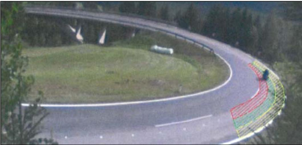
[Abbildung 14](#): Klassifikation von Kurvenfahrten einspuriger Kfz nach Segmenten (gelb = Fahrbahnrand, grün = Fahrstreifenmitte, rot = Kurvenschneiden) [24]
