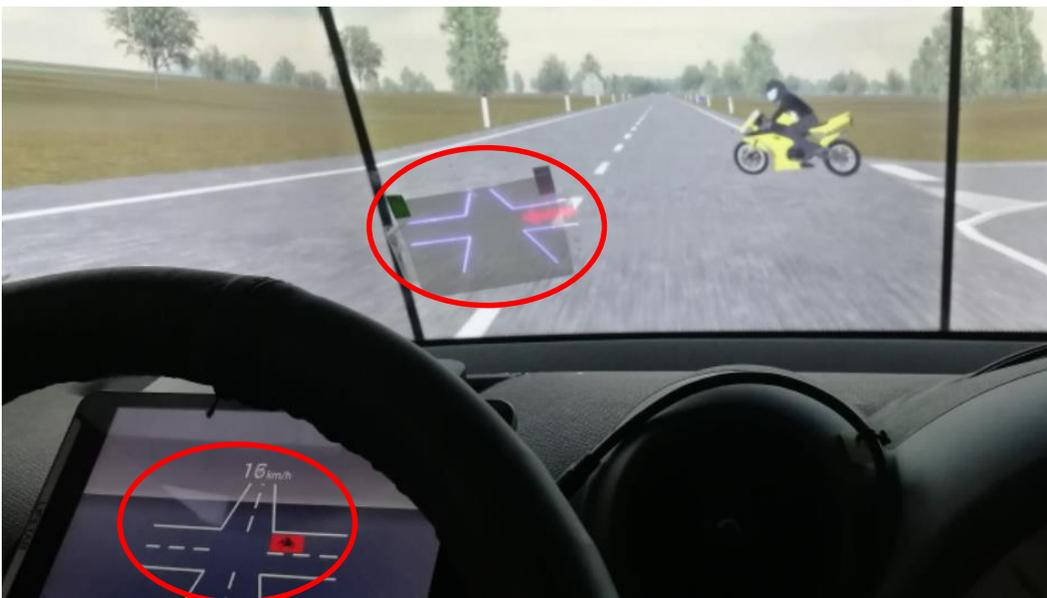
**ABB 6 Die visuelle Motorradwarnung angezeigt am Instrumentenbrett am Tablet-PC und auf der Windschutzscheibe im HUD. Die Richtung des kommenden Motorrades wird im rot an der schematisierten Darstellung der Kreuzung abgebildet.**
