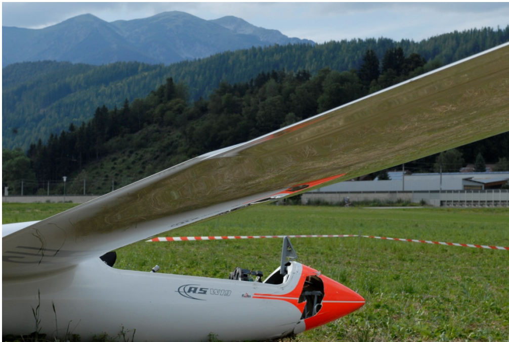
Beschädigung am Luftfahrzeugrumpf
