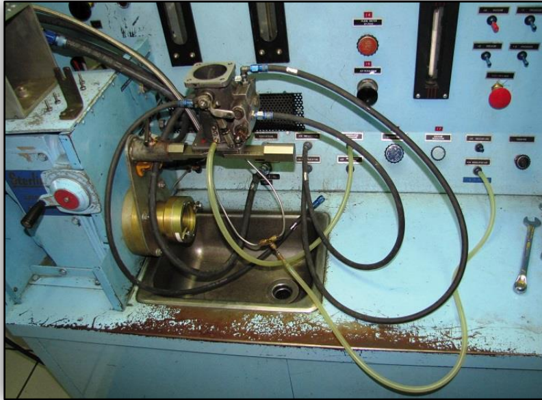
Abb. 6: Überprüfung der Kraftstoff-Einspritzanlage am Teststand - Quelle: SUB
