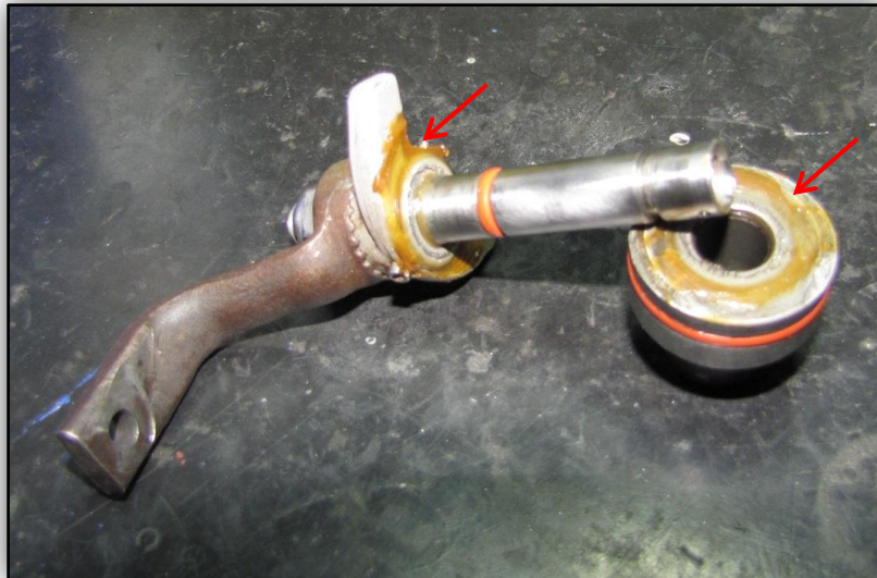
Abb. 8: Manuelle Gemischreglerwelle mit Schmiermittel – Quelle: SUB
