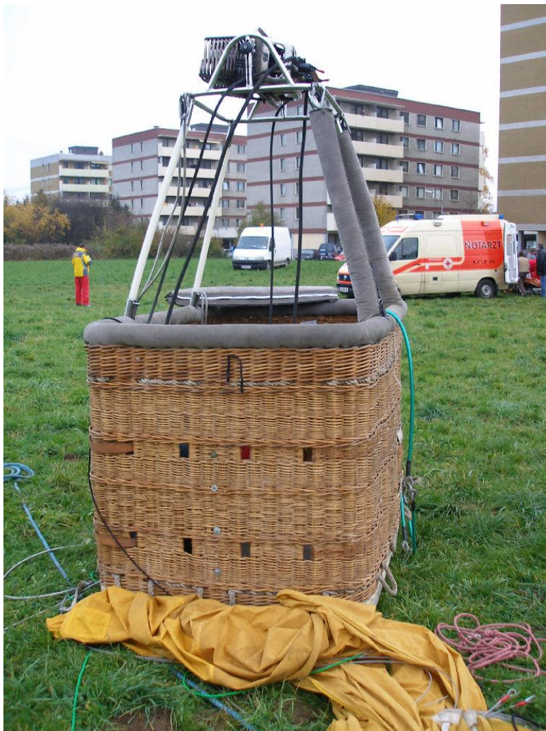
Abbildung 1 Ballonkorb mit den Seilen für den Fesselstart
