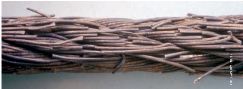
Ein durch Brand völlig zerstörtes Seilbahnseil
