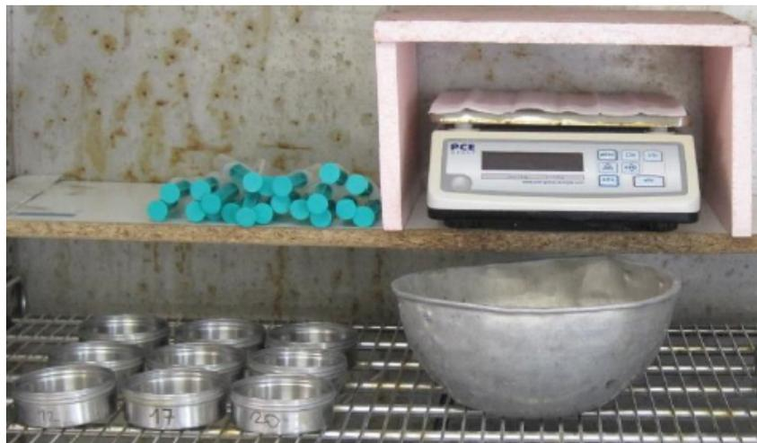
Abbildung 6: Methodik zur Bestimmung der Tauleistung flüssiger Taumittel
