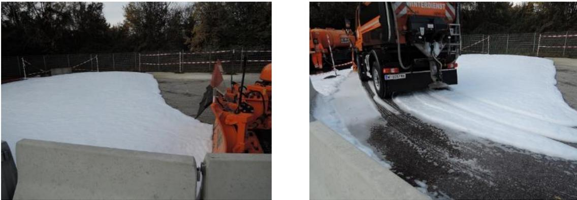
**Abbildung 64: Löschaum als Schneersatzmaterial**
