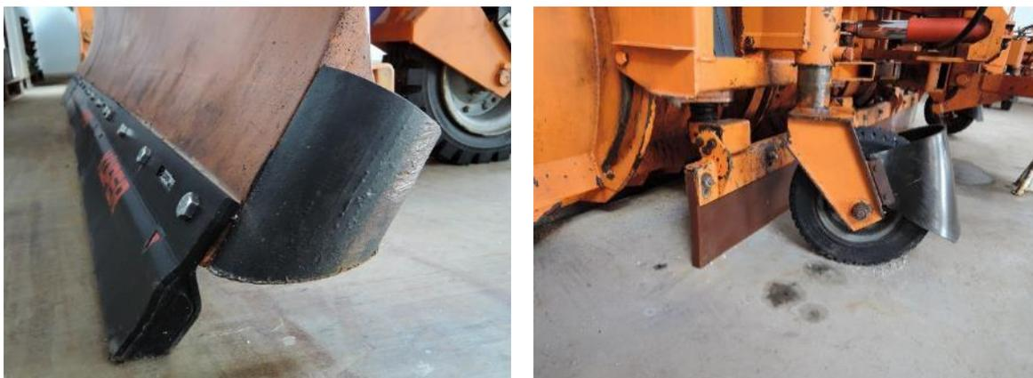
**Abbildung 57: v.l.n.r. Kombinationsräumleiste und Nachräumleiste**
