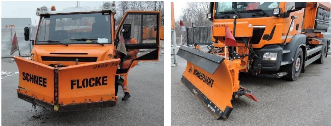
**Abbildung 56: v.l.n.r. Flötzing DKV-A und Springer SHL 3204 mit Nachräumklavier**
