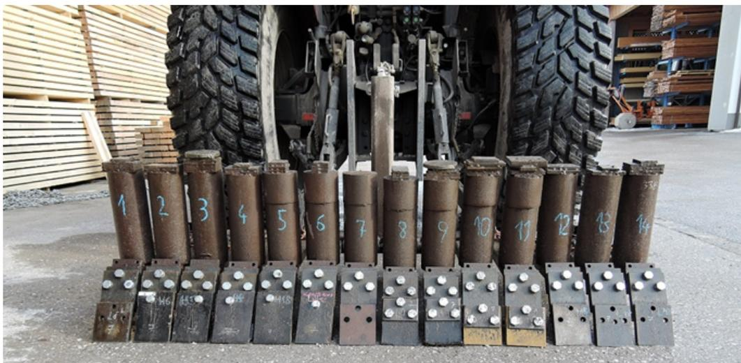
Abbildung 80: Erste Charge des Verschleißversuchs
