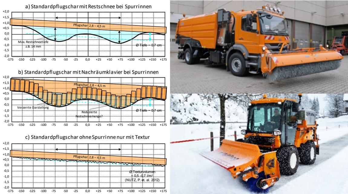
**Abbildung 104: Untersuchung von Querebenheit für Beurteilung von Räumequipment**
