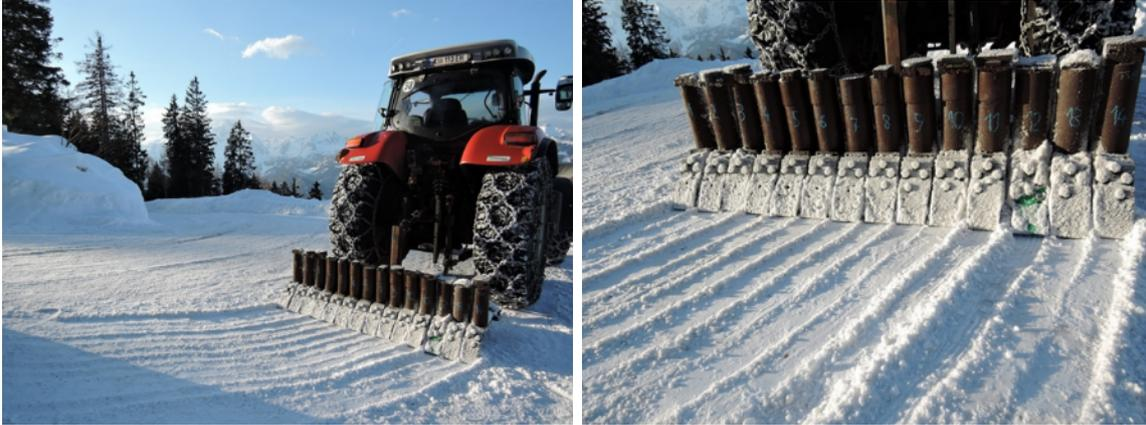
Abbildung 79: Feldversuch Verschleiß der Räumleistensegmente
