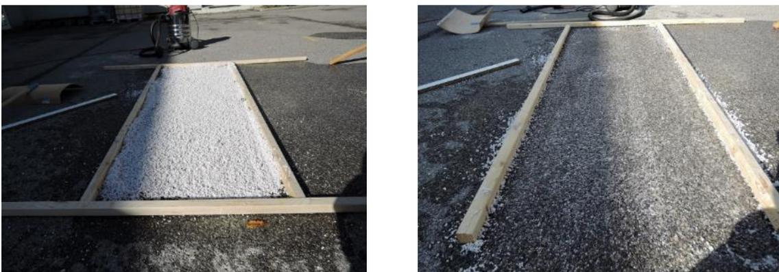
**Abbildung 65: befeuchtete Wärmedämmschüttung als Schneersatzmaterial**
