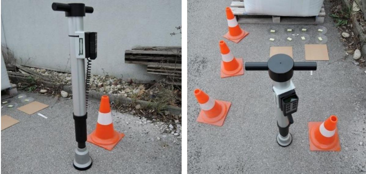
**Abbildung 91: SOBO20 Restsalzmessgerät**
