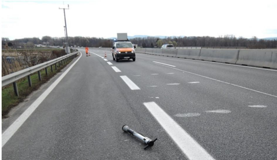
**Abbildung 98: Messpunkte der Restsalzmessungen mit SOBO 20**
