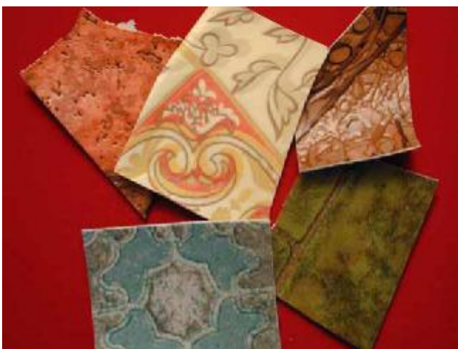
Foto 8: Vinylbodenplatten mit Asbestfasern an der Unterseite (SUVAPRO 2007)
