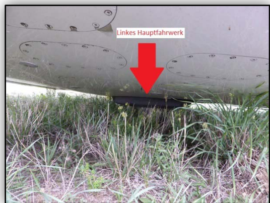
Linkes Hauptfahrwerk wurde vollständig eingefahren vorgefunden Quelle: SUB sowie Flughafen Wien-Schwechat
