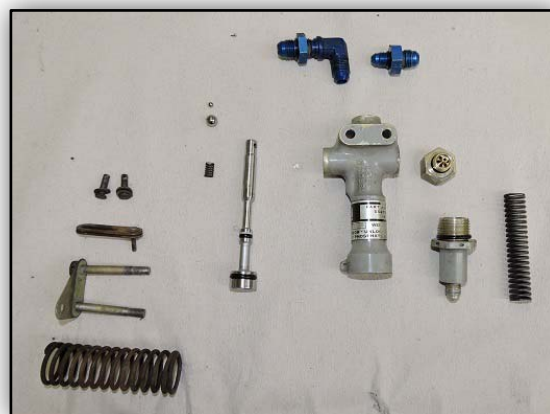
Fahrwerksteuerventil zerlegt Quelle: SUB
