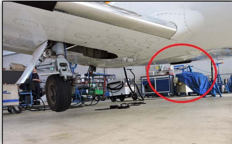
Linkes Hauptfahrwerk bleibt eingefahren, obwohl „Down“ selektiert wurde und das rechte Hauptfahrwerk als auch das Bugfahrwerk ausgefahren waren. Quelle: SUB
