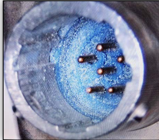
Steckkontakt an der Aussenseite Downlock Sensors Quelle: SUB
