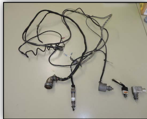
Kabelbaum und Sensoren des linken Hauptfahrwerks Quelle: SUB
