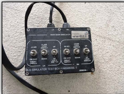
Teil der Testausrüstung zur Fahrwerksüberprüfung Quelle: SUB
