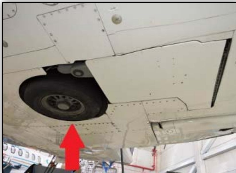
Linkes Hauptfahrwerk bleibt eingefahren, obwohl „Down“ selektiert wurde und das rechte Hauptfahrwerk als auch das Bugfahrwerk ausgefahren waren. Quelle: SUB
