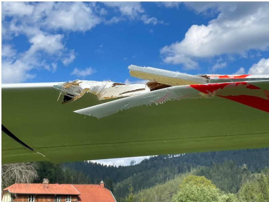
Abbildung 25: Beschädigung der linken Tragflächenspitze
