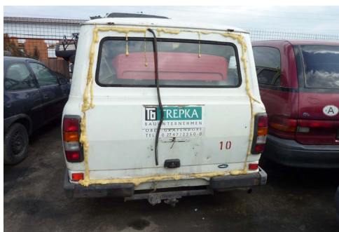
Abbildung 117: Autowrack, nicht schadstoffentfrachtet – nicht gelisteter Abfall
