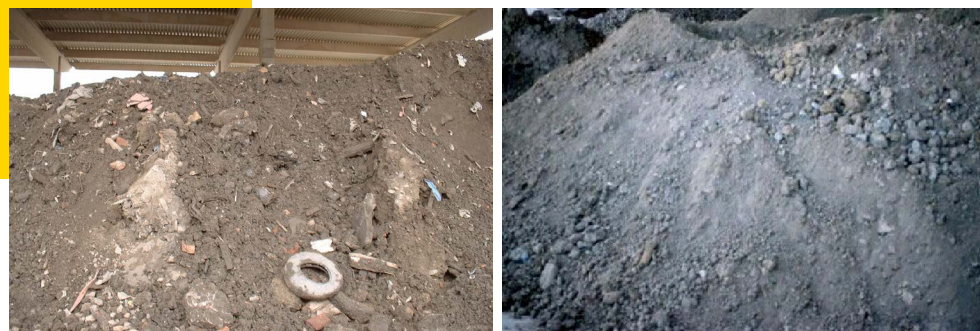
Abbildung 272: Erdaushub aus Deponiesanierung
