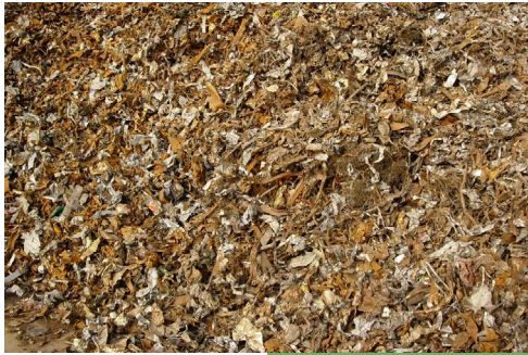
Abbildung 67: Diverser Eisenschrott, teilweise korrodiert
