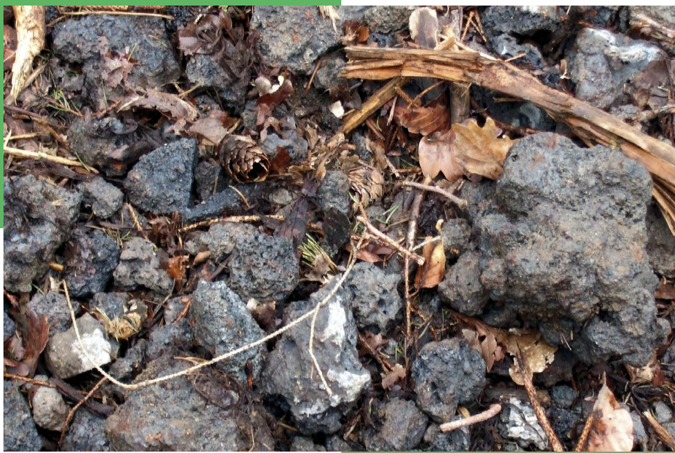
Abbildung 64: Elektroofenschlacke (chromhaltig) aus einem Edelstahlwerk – Grüne Liste bei zulässiger Anwendung – Nota bene: Aufschüttung auf Böden/Wegen ist illegal!
