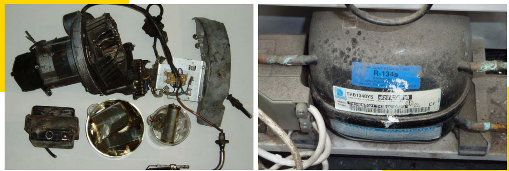
Abbildung 85: Elektromotor mit PCB-Anlasskondensator – A1180
