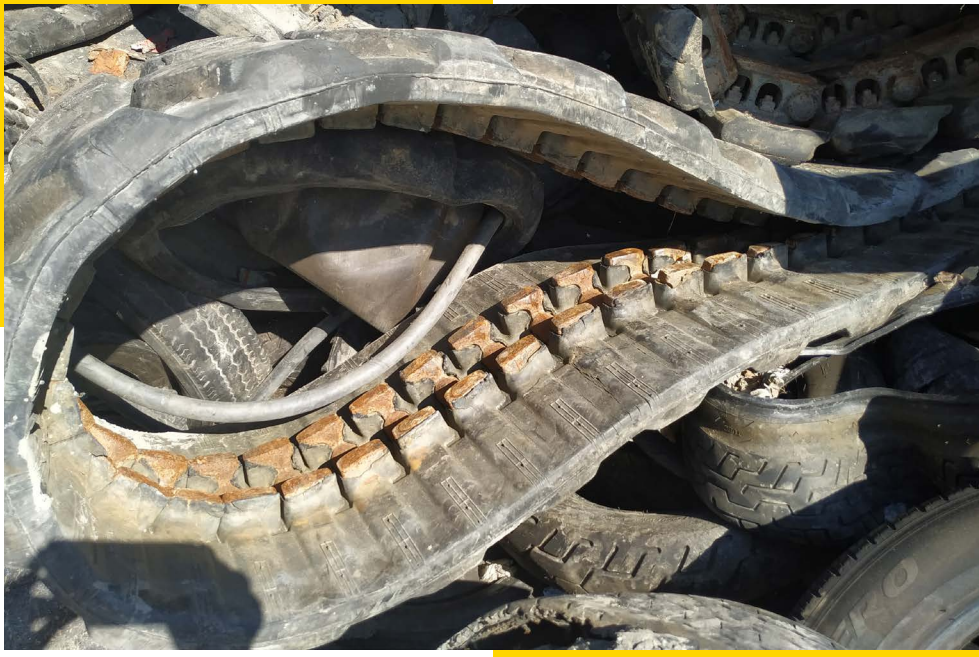
Abbildung 143: Baggerketten-Gummiabfälle mit sehr hohem Metallgehalt, schadstoffhaltig – nicht gelisteter Abfall
