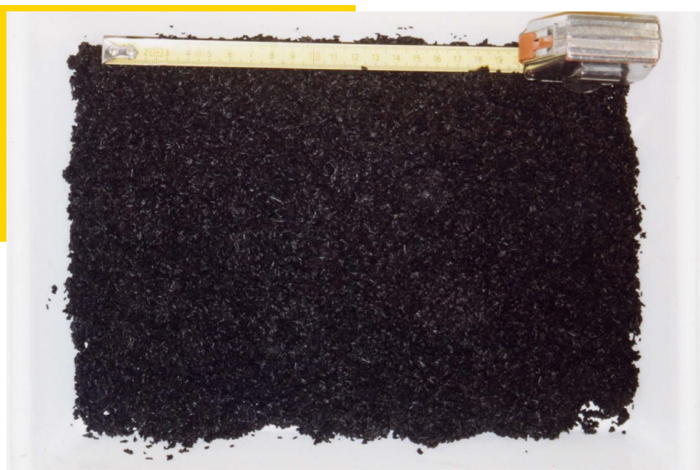
Abbildung 15: Kontaminierte Aktivkohle aus der Wassereinreinigung – A4160
