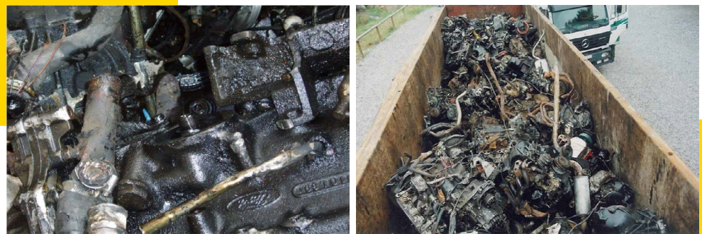
Abbildung 87: Nicht restentleerte Fahrzeugmotoren, kein Funktionsnachweis – A1180
