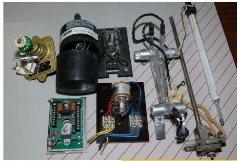
Abbildung 107: Mit gefährlichen Bauteilen bestückte Platinen – A1180
