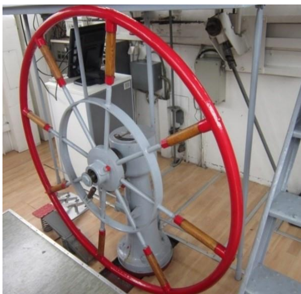
Abbildung 15 Mechanisch direkt wirkende Notrudereinrichtung unter dem normalen Steuerstand der "SCHÖNBRUNN"
