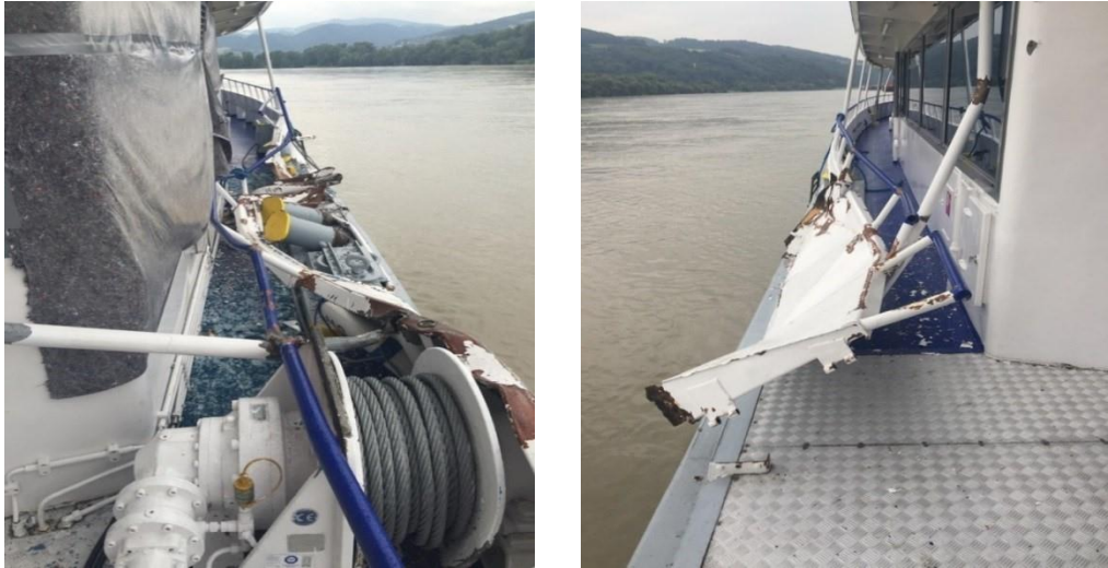
Abbildung 9 Beschädigung auf der Steuerbordseite der "AUSTRIA"
