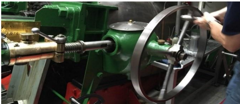
Abbildung 12 Maschinist "SCHÖNBRUNN" bei der Einstellung der Fahrtrichtung und Leistung
