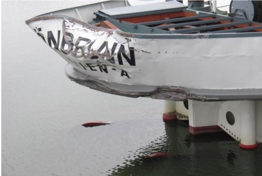
Abbildung 7 Beschädigung am Heck der "SCHÖNBRUNN"
