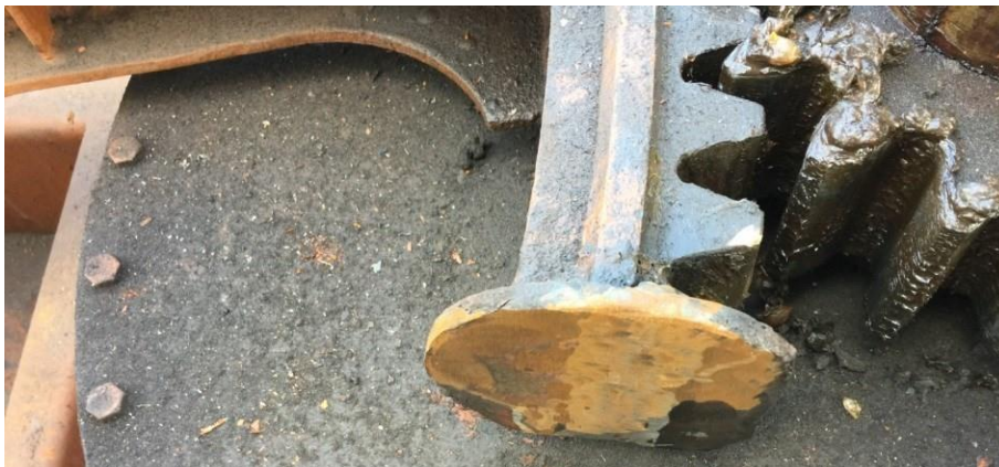
Abbildung 20 Geschweißte Anschlagplatte des rechten Quadranten, wenn der linke Quadrant am Anschlagpuffer anliegt (siehe auch Abb. 21)
