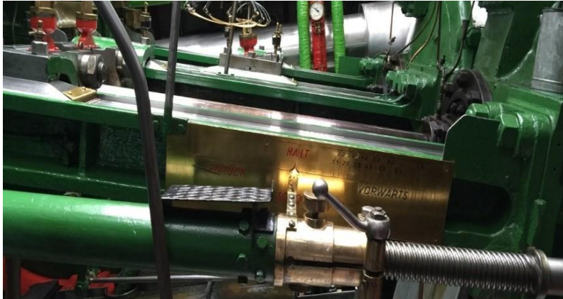
Abbildung 11 Stellspindel der "SCHÖNBRUNN" - Vor- und Rückwärts
