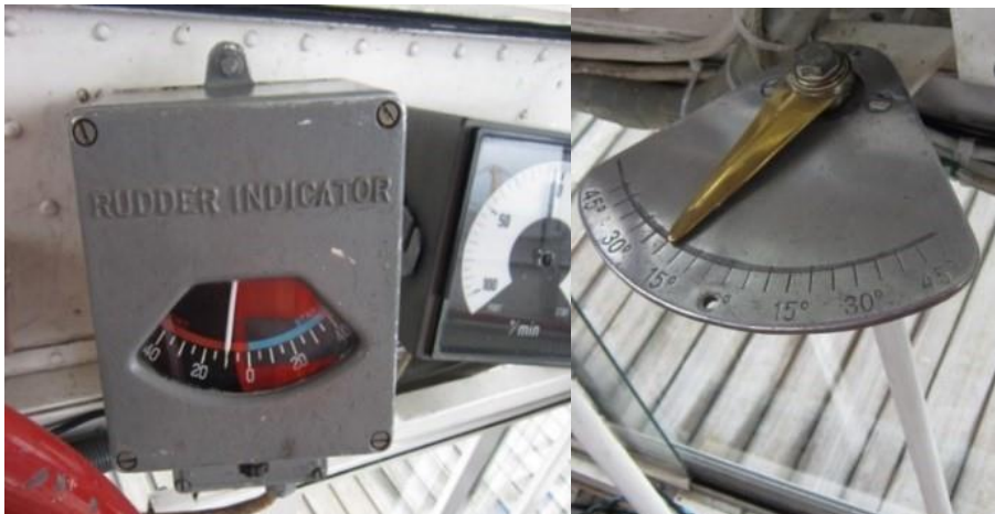
Abbildung 14 Elektrischer und mechanischer Ruderlagenanzeiger der "SCHÖNBRUNN"
