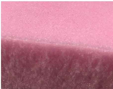
Abbildung 4: Bruchfläche einer XPS-Dämmplatte, Bild: Johann Jandl (ÖXPS)
