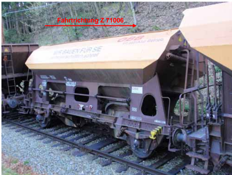
Abbildung 9 Entgleister 13. Wagen von Z 71006, Blick von links - Quelle StH
