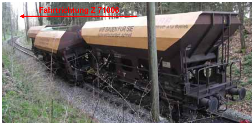
Abbildung 8 Entgleister 13. Wagen von Z 71006, Blick von rechts - Quelle StH
