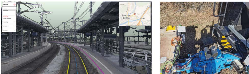
Abbildung 19: Beispiel für die Detektion von diversen Elementen und Digitale Automatische Kupplungen (DAK) zweier Eisenbahnwagen inklusive Messtechnik auf einem Testzug für die Feldtests © ÖBB Infrastruktur AG © Rail Cargo Group
