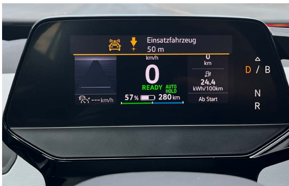
Abbildung 14: C-ITS-Warnmeldung im Auto © ASFINAG
