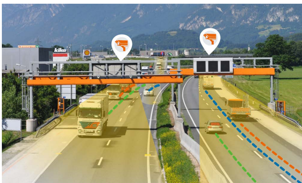
Abbildung 15: Teledyne-FLIR-Dualkameras ermöglichen eine qualitativ hochwertige Klassifizierung, Zählung und Ereigniserkennung © ASFINAG
