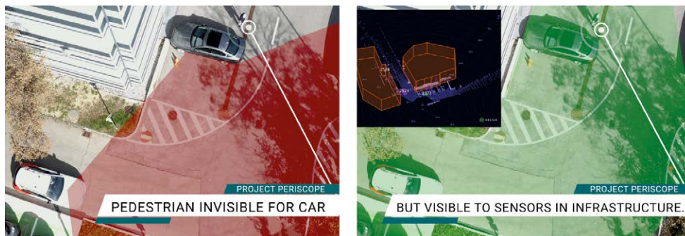
Abbildung 11: Blickfeld des Testfahrzeugs mit Fußgängerin oder Fußgänger im toten Winkel versus Blickfeld des Sensors inklusive Visualisierung der LiDAR-Datenerfassung: sowohl Fahrzeug als auch Fußgängerin oder Fußgänger © ALP.Lab
