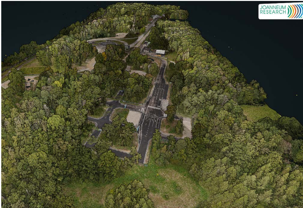
Abbildung 3: Digitaler Zwilling des DIGITRANS-Prüfgebietes in St. Valentin, welcher mittels Laserscanner vom Fahrzeug, von der Drohne und personengetragen aufgenommen wurde © bernhard-bergman
