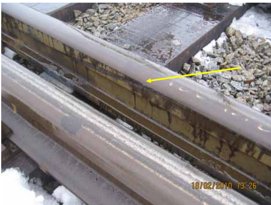
Abbildung 18 Stelle der ersten Entgleisungspur - Quelle StH
