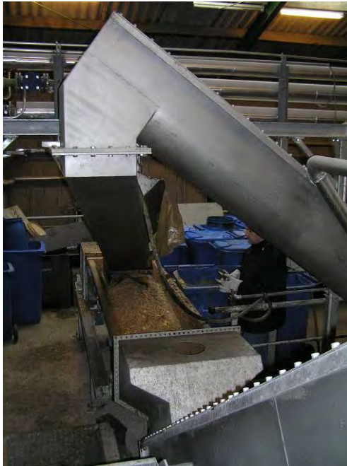
Abbildung 2-7: Visuelle Kontrolle und händische Störstoffentfernung aus Küchenabfällen (Foto: © IFA Tulln)
