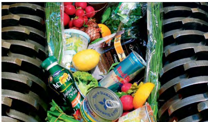
Abbildung 2-9: Zerkleinern von Bioabfällen (Foto Fa. UNTHA shredding technology)
