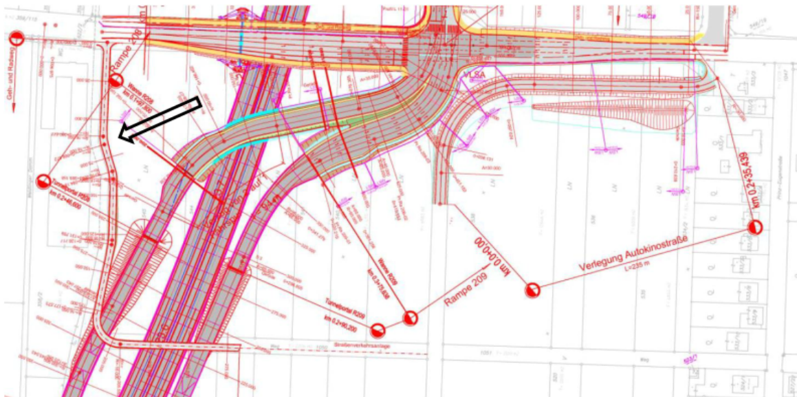
Abbildung 27: Projektänderung: Lageplan Geh- und Radwegverbindung in Verlängerung bereits ausgewiesener Straßenverkehrsanlagen (Quelle: Änderungsoperat, Einlage 2.3)
