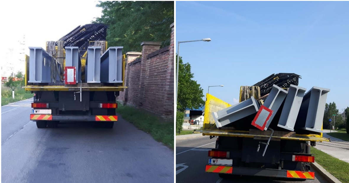
Lkw mit 4 I-Trägern, vor und nach einer Unterführung © KfV
