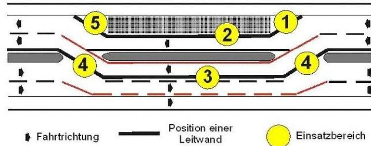
Bei Antragstellung auf Einsatzfreigabe für temporäre Fahrzeugrückhaltesysteme ist somit der Nachweis für die Rückhalteklassen T3 bzw. H1 zu belegen (weitere unter Rücksichtnahme auf die v.g. max. Wirkungsbereiche).
